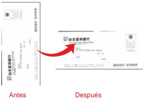
La función de auto rotación del documento permite que el escáner rote automáticamente cada imagen salvada en una dirección legible, basada en el lenguaje OCR especificado. Los usuarios no necesitan rotar el documento manualmente cuando están escaneando, ahorrando así tiempo y energía.
