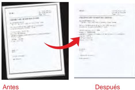
Para ahorrar el esfuerzo de las personas, las funciones de autocorte (Auto-crop) y eliminación de distorsión permiten que los escáneres de Microtek detecten automáticamente el tamaño de la imagen y luego corten el marco adaptado a la imagen. Al mismo tiempo, también pueden eliminar los indeseados bordes negros.
